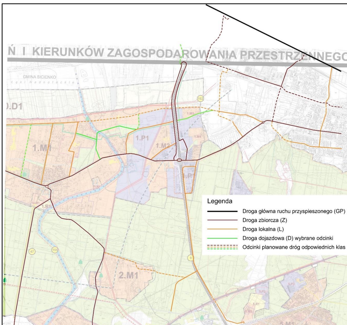
Rys. 4.7. Wariant 6a rozwoju sieci drogowo-ulicznej obszaru Lisiego Ogona (źródło: opracowanie własne z wykorzystaniem Studium uwarunkowań i kierunków zagospodarowania przestrzennego gminy Białe Błota – Uchwała Rady Gminy Białe Błota RGK.0007.159.2022 z dnia 27.12.2022)
